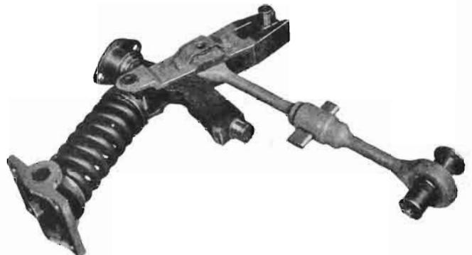
Fig. 9. — Dessin schématique de la boîte d'essieu avec guides et suspension primaire.
